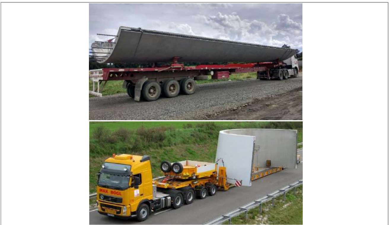
Abbildung 10: Transport der Keystones der Türme TC100N / TC120N-01 / TCS162-00 / TCS168N-00 / TCS179-00 (top) und TCS164B-XX / TCS179-00 (bottom)
